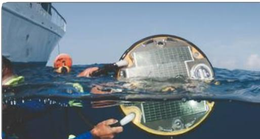
Con un indicatore a energia solare si misura la temperatura del mare
